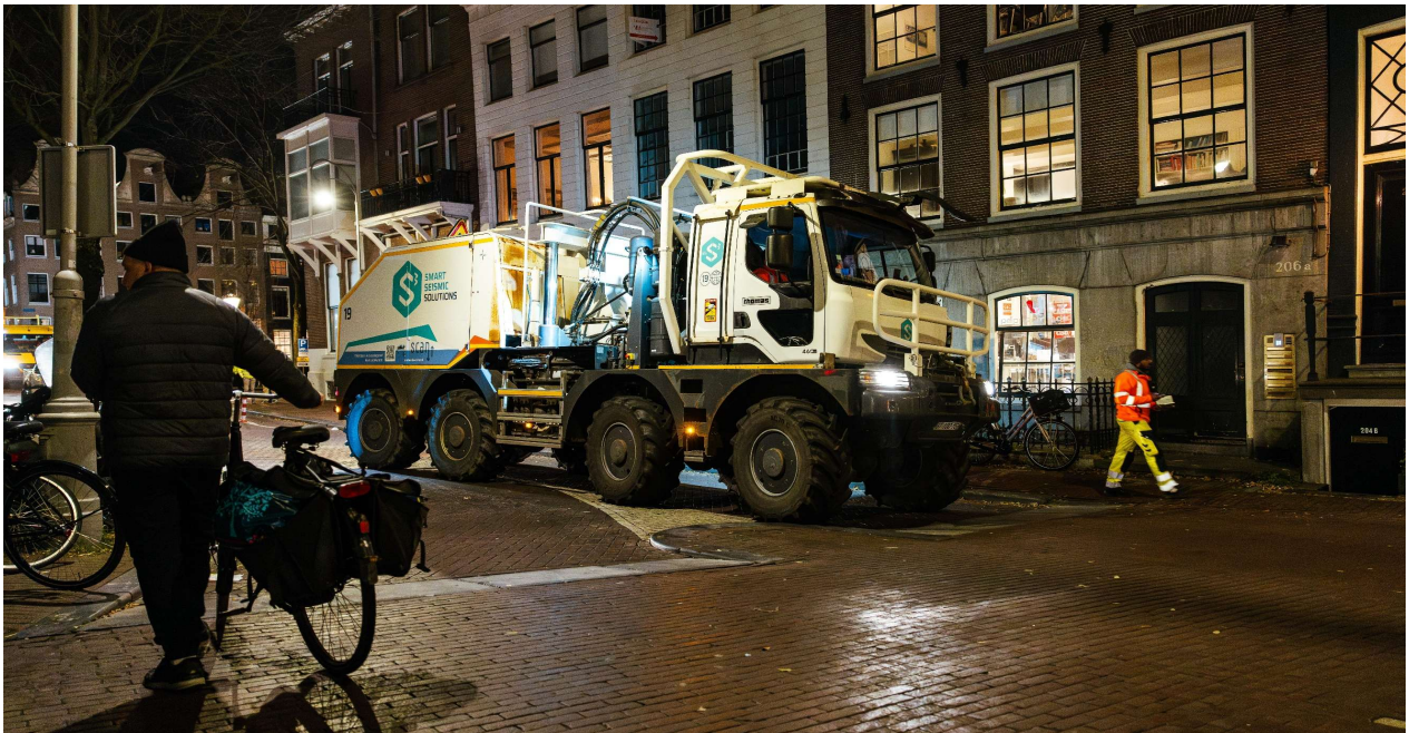
Seismisch onderzoek met vibroseisvoertuig in uitvoering in Amsterdam in 2025
