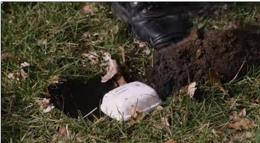
Figuur 4 Een grondmicrofoon geplaatst in een ondiepe kuil (Bron: EBN B.V.)
