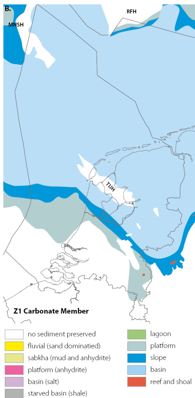
Figuur 6-1: Sedimentaire facieskaart voor het Zechstein 1 carbonaat (Bouroullec & Geel in ten Veen et al., 2025).
