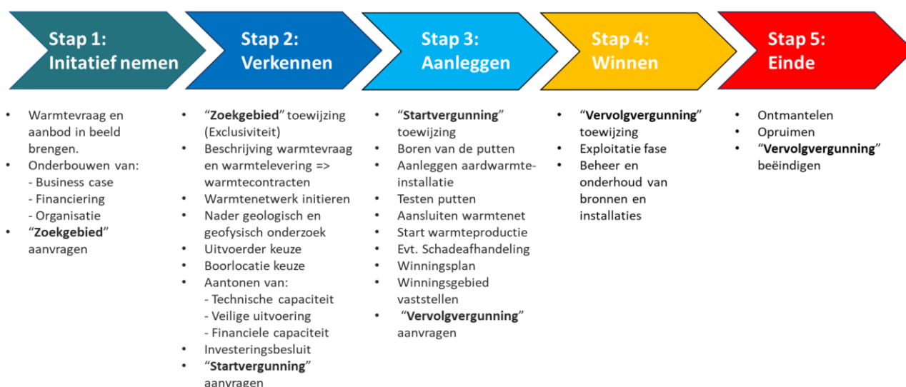
Figuur 0-5: De vijf stappen die een aardwarmteproject doorloopt, inclusief de verschillende activiteiten die ondernomen worden per stap (geothermie.nl, ECW.nl).
