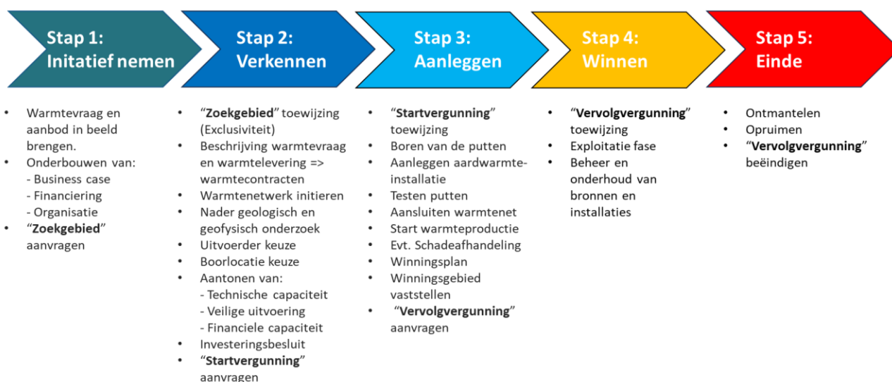
Figuur 7-9: De vijf stappen die een aardwarmteproject doorloopt, inclusief de verschillende activiteiten die ondernomen worden per stap (geothermie.nl, ECW.nl).
