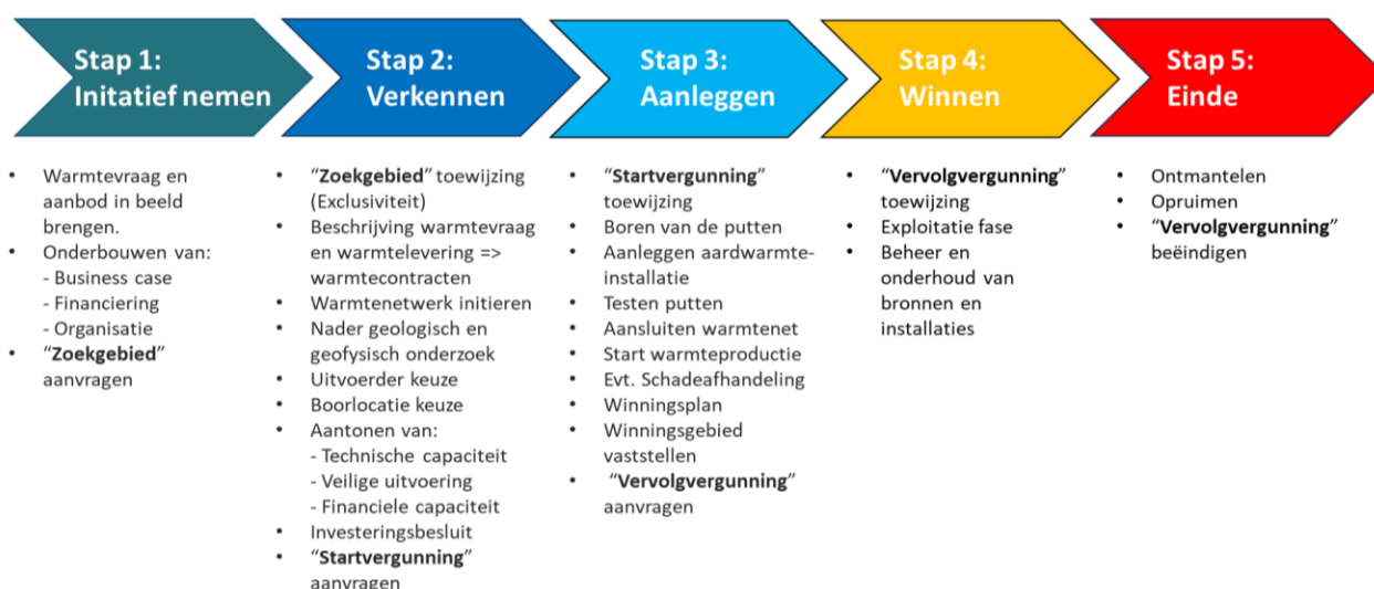
Figuur 7-7: De vijf stappen die een aardwarmteproject doorloopt, inclusief de verschillende activiteiten die ondernomen worden per stap (geothermie.nl, ECW.nl).
