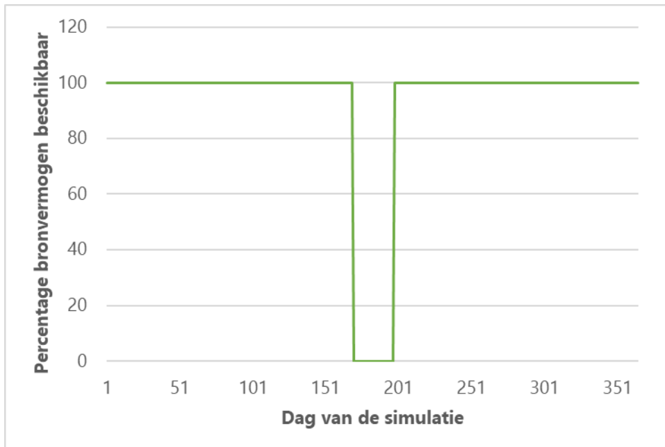
Figuur 10. Aanbodprofiel geothermiebron. De simulaties zijn uitgevoerd met een productiestop voor onderhoud van 28 dagen in de zomer.
