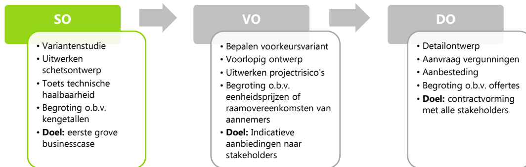
Figuur 5. De verschillende ontwerpfasen en bijbehorende werkzaamheden. De achtereenvolgende fasen zijn schetsontwerp (SO), voorlopig ontwerp (VO) en definitief ontwerp (DO).
